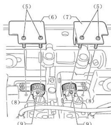
3. Открутите винты (5), а затем снимите крышки основания челноков FL (6) и FR (7).
