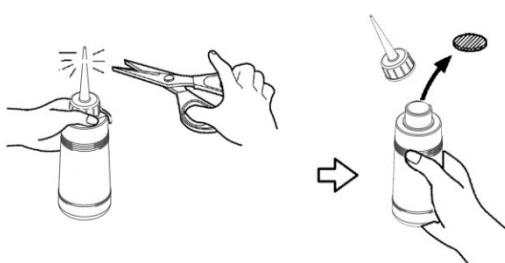
Швейную машину всегда следует смазывать и пополнять запас масла перед первым использованием, а также после длительного простоя.
