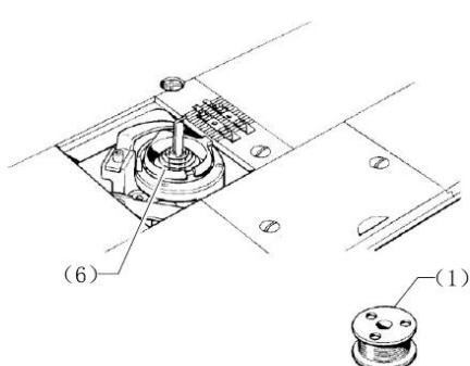
Внутри челночного устройства находится пружина (6) для предотвращения раскручивания шпульки.
