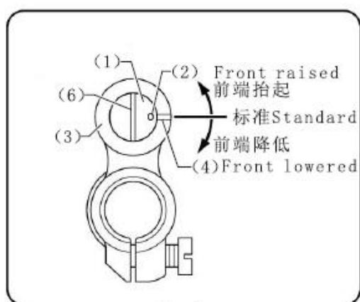
1. Стандартным углом наклона зубчатой рейки является положение, когда метка (2) на оси (1) совпадает с контрольной линией (4) рычаге зубчатой рейки (3).
