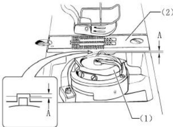
Зазор (A) между установочным пальцем (1) и игольной пластиной (2) составляет 1,4-1,7 мм.
