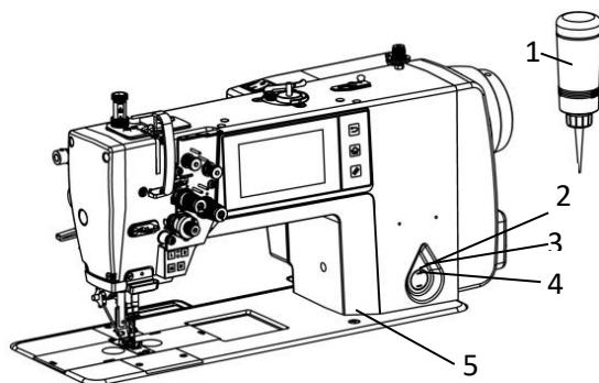
1. Используйте маслёнку (1) для заливки масла в отверстие для смазки (5). Заливайте масло до тех пор, пока уровень масла не достигнет верхней контрольной линии (2) окошка контроля масла (3).
