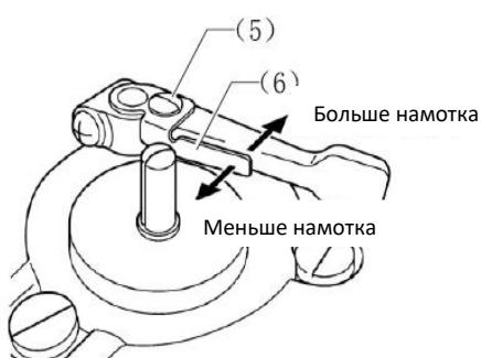
\* Ослабьте винт (5) и переместите прижимную пластину (6), чтобы отрегулировать количество нити, наматываемой на шпульку
