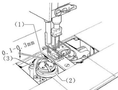
1. Ослабьте установочный винт (3) и переместите отводчик (1) влево или вправо, чтобы отрегулировать зазор между шпульодержателем (2) и отводчиком (1). Зазор должен составлять 0,1-0,3 мм при начале движения отводчика (1), когда он начнёт двигаться в направление стрелки.
