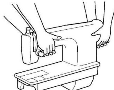
Перекладину стола (B) прижмите ногой, чтобы стол не двигался, а затем обеими руками надавите на корпус, чтобы отклонить назад головку машины
