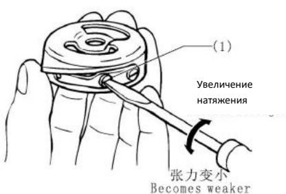
Поверните регулировочный винт (1) для регулировки натяжения.
