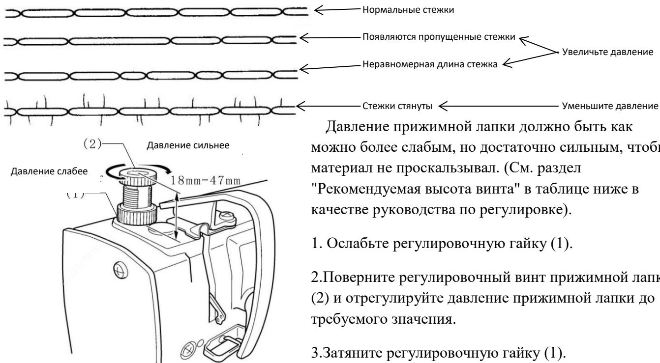
1. Ослабьте регулировочную гайку (1).
