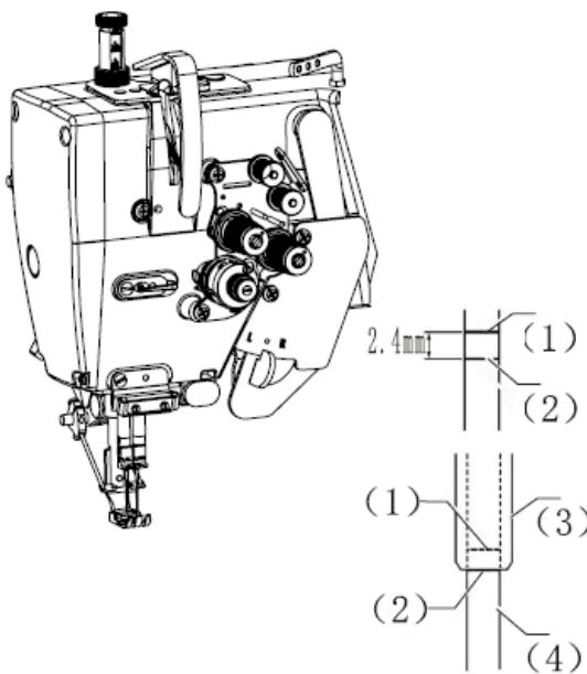
1. Поверните маховое колесо против часовой стрелки, чтобы игловодитель (4) поднимался до тех пор, пока его базовая линия (2) не совпадет с нижним концом втулки игловодителя (3).
