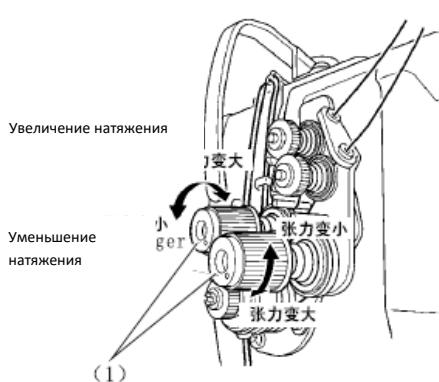
После регулировки натяжения нижней нити отрегулируйте натяжение верхней нити таким образом, чтобы получился хороший ровный стежок.
