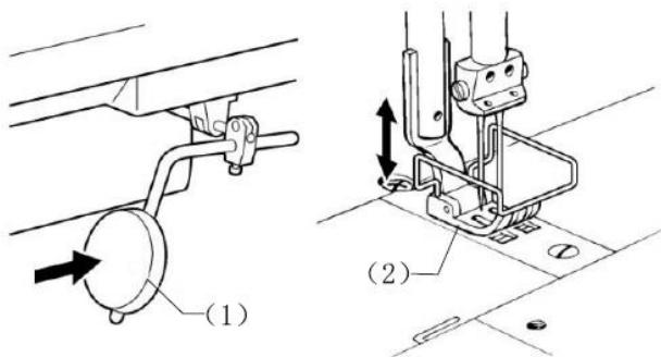
Прижимную лапку (2) можно поднять, нажав на пластину (1) коленоподъёмника.
