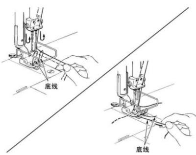
1. Удерживая две верхние нити пальцами, вручную поверните маховое колесо на себя, пока нижние нити не выйдут из отверстий зубчатой рейки.
