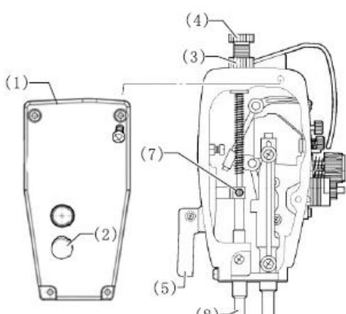
1. Снимите фронтальную крышку (1) и снимите резиновую заглушку (2).
