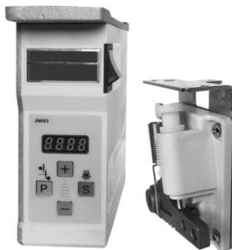
Сервопривод состоит из двух частей – контроллера и электромотора.
